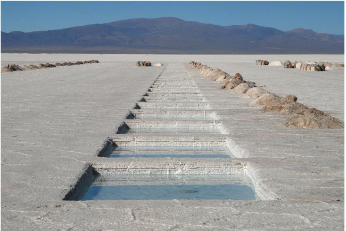
**Fig. 10.** Vista de piletas de evaporación cortadas en la costra del salar con presencia de salmueras sobresaturadas y enriquecidas en litio (Salinas Grandes, Salta-Jujuy).
