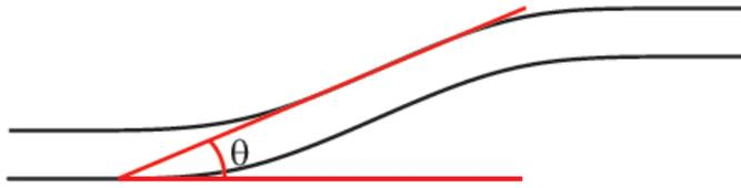
**Fig.13.** Esquema de un desviador integrado.
