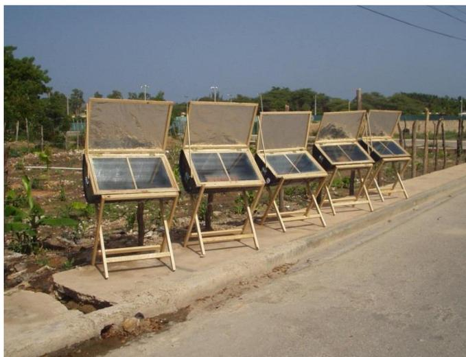
Figura 3. Cocinas solares fabricadas en INENCO (unas-CONICET)
