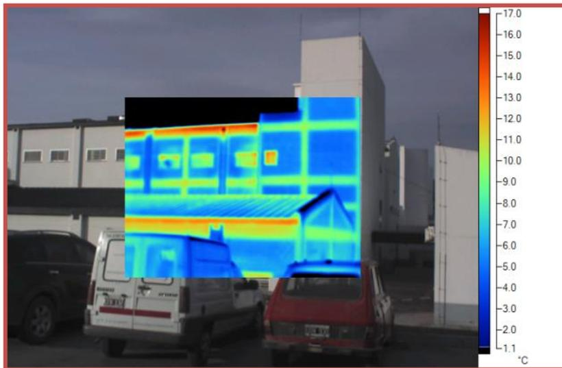
Fig. 7. Imagen termográfica del Nuevo Hospital de Niños, Salta. Se observan las pérdidas de calor a través de la estructura de hormigón.
