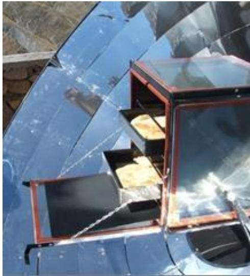
Figura 8. Concentrador con un horno produciendo pan
