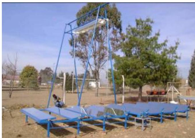
Figura 7. Prototipo de concentrador lineal Fresnel – INENCO, U.N.Sa.-CONICET.
