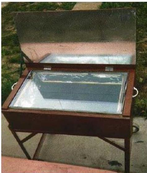
Figura 2. Cocina caja fabricada en madera de álamo, construida en la Provincia de Mendoza
