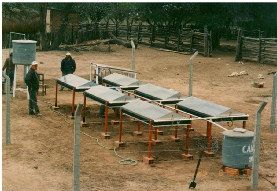
Figura 3. Destiladores solares en la localidad "El Quemado". Abastece de agua a dos familias
