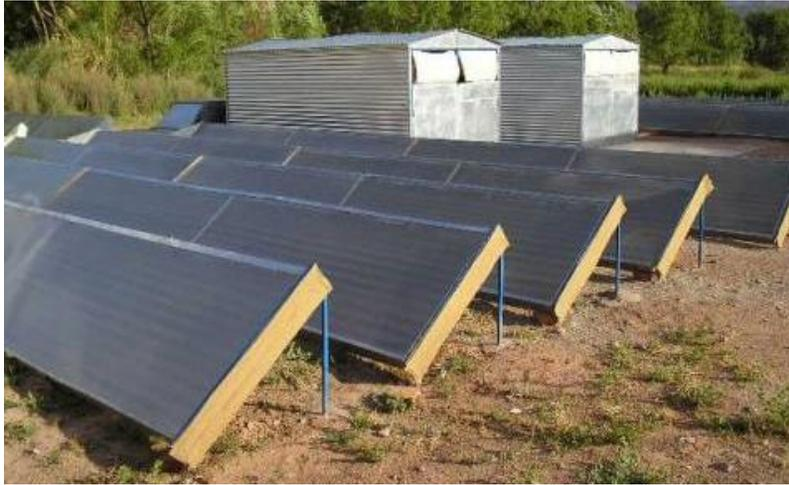
Fig. 8. Secador solar de hortalizas. Capacidad de carga 500 kg
