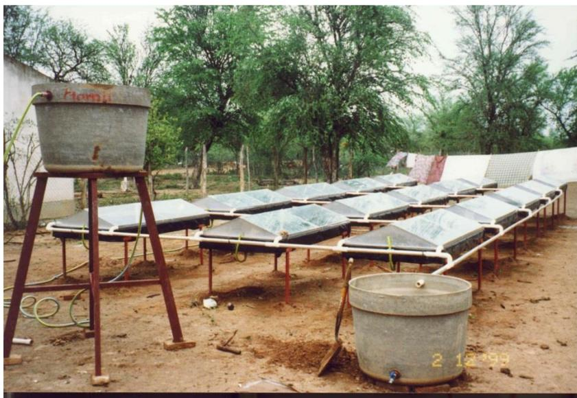
Figura 2. Destiladores solares en la localidad "Pozo la China".
