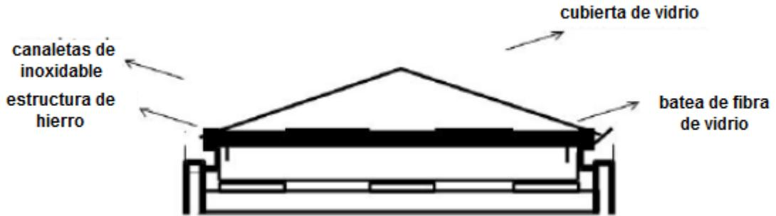
Figura 4. Corte de uno de los módulos
