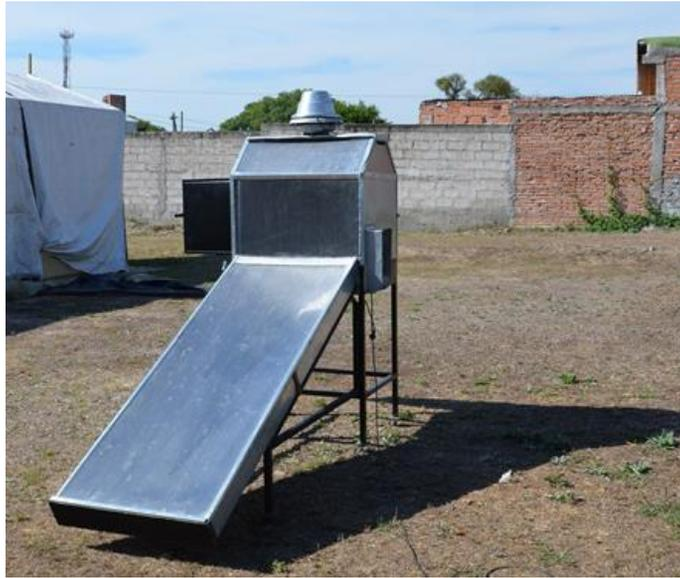
Fig. 5. Secador hibrido solar-eléctrico, indirecto tipo gabinete
