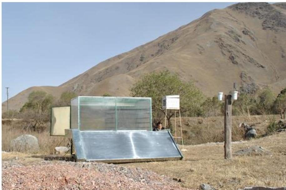
Fig. 4. Secador híbrido solar-eléctrico, directo, tipo gabinete
