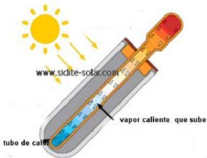
Figura 6. Tubo de calor
