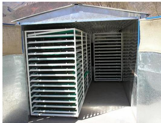
Fig. 10. Puerta de ingreso y carros en el interior de la cámara de secado
