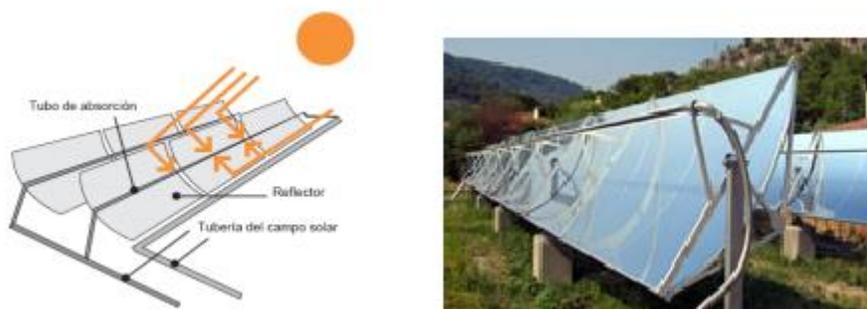
Figura 3. Esquema y foto de concentradores cilíndricos parabólicos.
