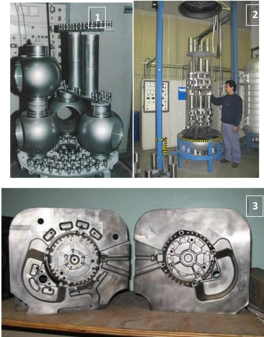
Figura 8. Ejemplos de aplicaciones industriales. 1) Cuerpos de válvula de acero inoxidable; 2) Cigüeñales de grandes compresores; 3) Matrices para inyección de piezas de aluminio.
