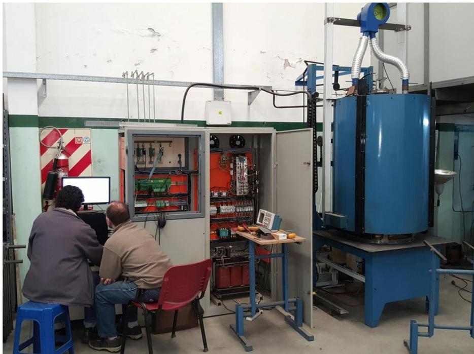
Figura 9.- Equipo de procesos por plasma para desarrollo de tecnologías asociadas a tribología e ingeniería de superficies. Zona útil: diámetro 500 mm, altura 800 mm.
