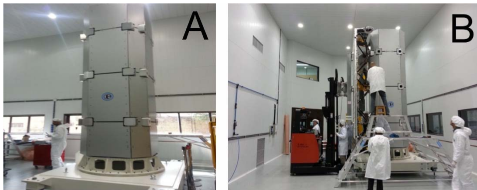
Fig. 19. A: Integración en CNEA del Modelo Estructural de la Antena SAR; B: Integración en CNEA del Modelo Estructural de la Antena SAR.
