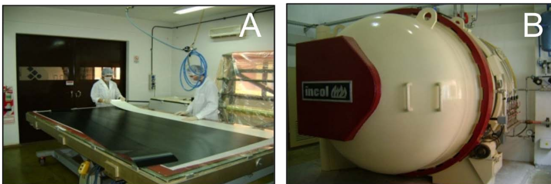
Fig. 14. A: Elaboración de laminados de fibra de carbono; B: Autoclave para el proceso de polimerización.
