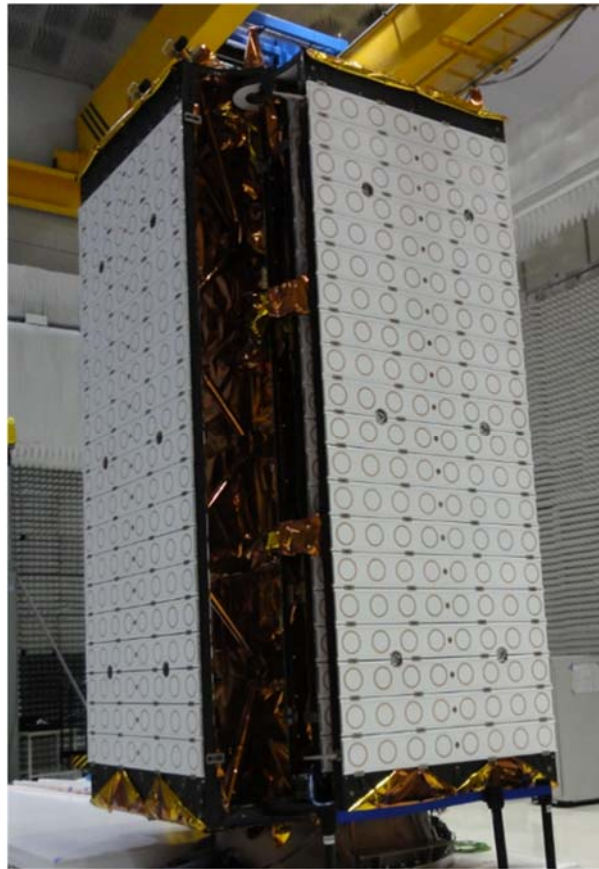
Fig. 24. Satélite con la antena SAR plegada en configuración de lanzamiento.
