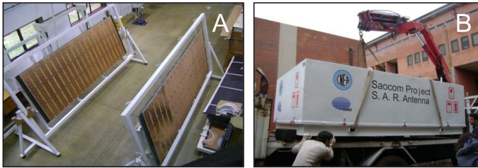
Fig. 16. A: Equipos de soporte para la integración de paneles; B: Contenedor de transporte.
