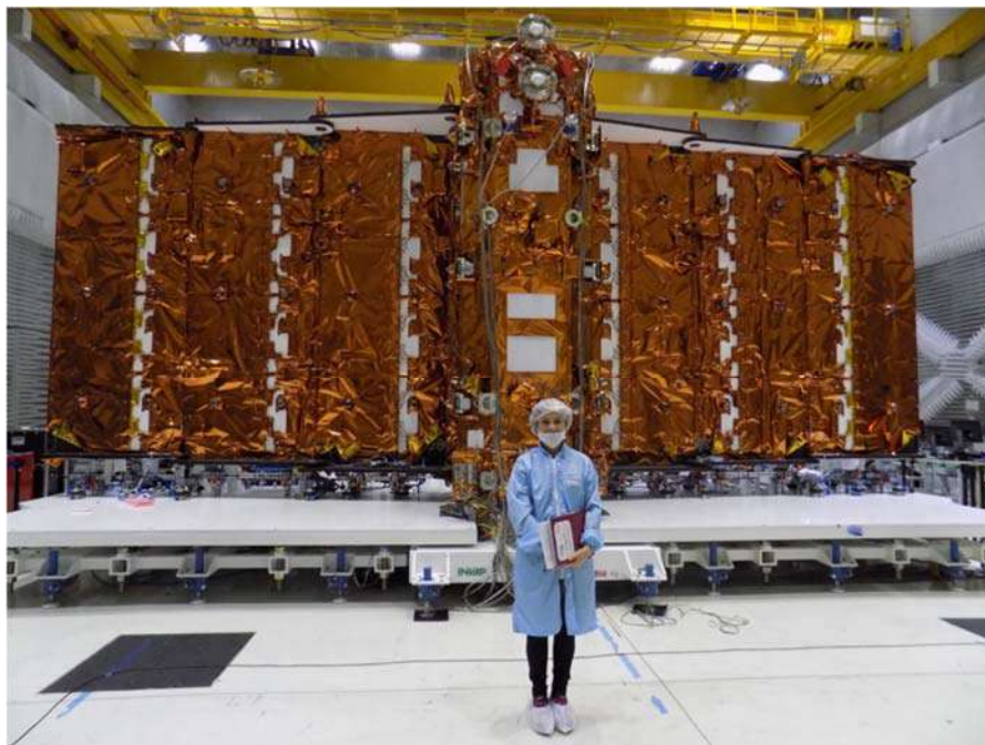
Fig. 23. Vista posterior de uno de los satélites con la antena SAR desplegada.
