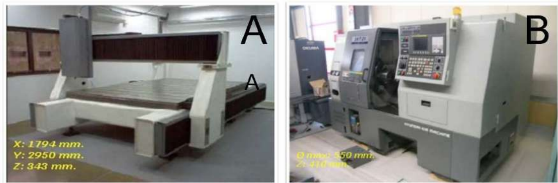
Fig. 15. A: Fresadora para el mecanizado de paneles; B: Equipo CNC para la fabricación de piezas metálicas.
