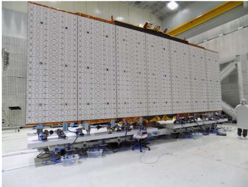
Fig. 22. Vista anterior de uno de los satélites con la antena SAR desplegada.
