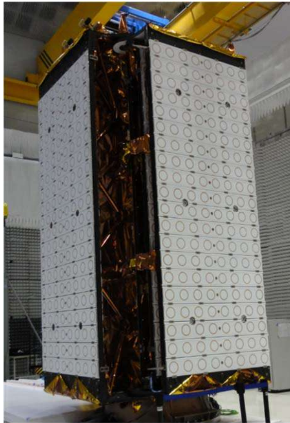
Fig. 24. Satélite con la antena SAR plegada en configuración de lanzamiento.
