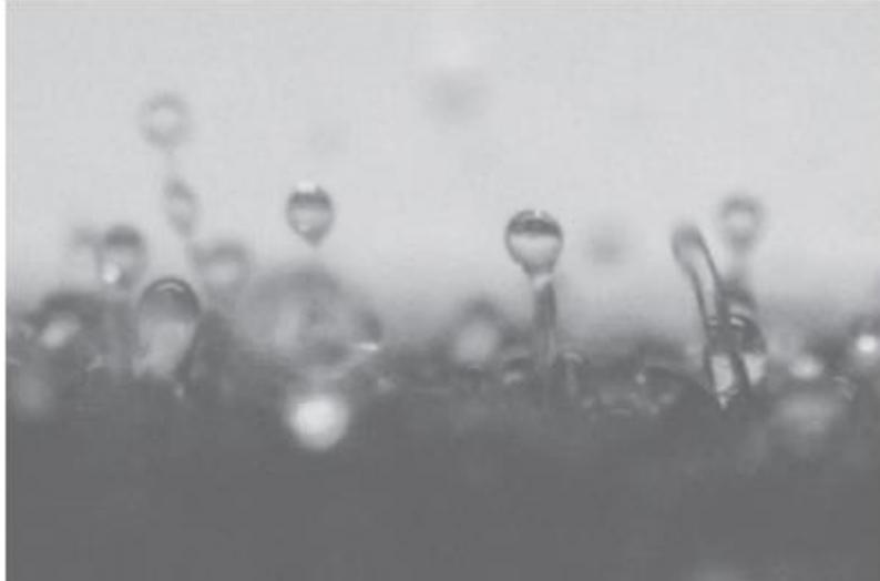
Fig. 6. Umbral de eyección de POE 250ppm,  $f=80\text{Hz}$  y  $a=4,2g$ .
