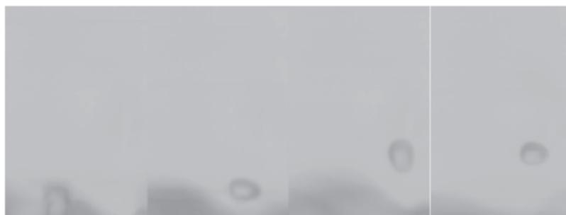
Fig. 15. Eyección de gota en el modo "volcán" POE 500ppm,  $f=70\text{Hz}$ ,  $a=3,5g$ , tiempo entre imágenes 0,014s.
