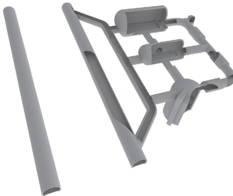
Fig. 1. Dibujo conceptual del laboratorio ANDES, ubicado en el km 4 de los 14 km del túnel Agua Negra (dirección Chile-Argentina).
