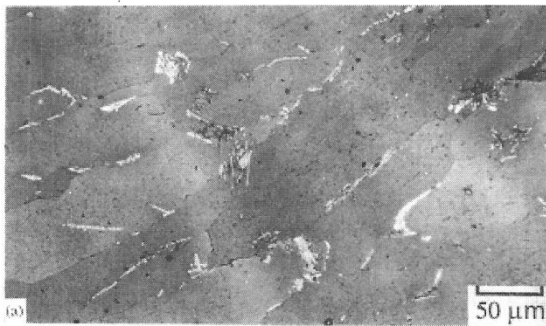
Fig. 14. Solidificación celular de un depósito de soldadura de acero de baja aleación realizado por el proceso GSFCAW.
