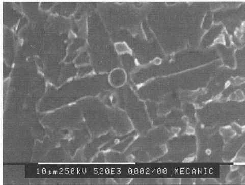
Fig. 19. Nucleación de placas de ferrita acicular sobre una inclusión no metálica.
