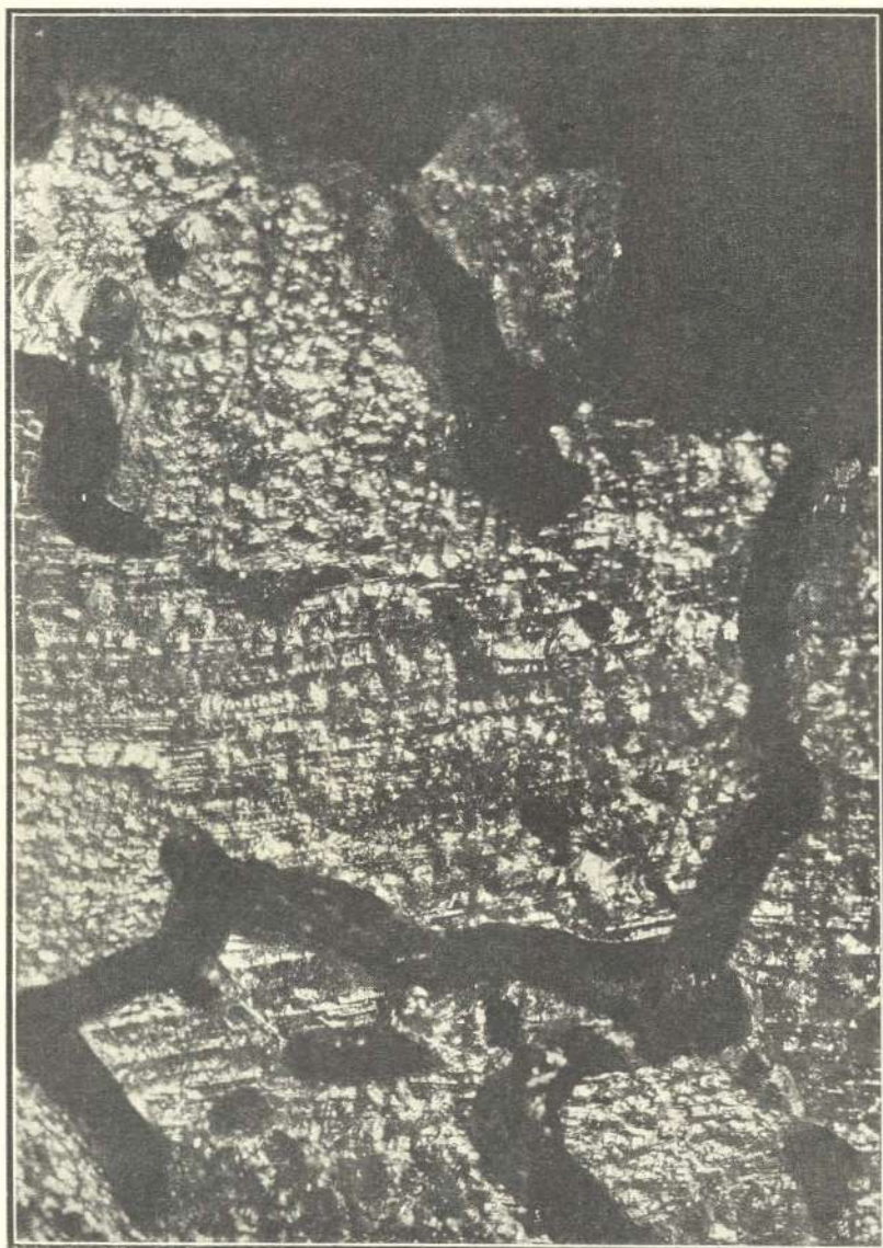
Fig. 2. — Figuras de corrosión de El Toba
