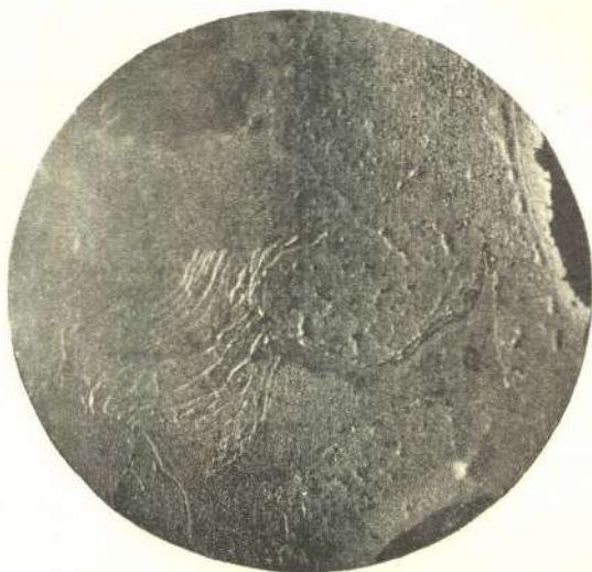
Fig. 4. — Estrias onduladas y nódulos
